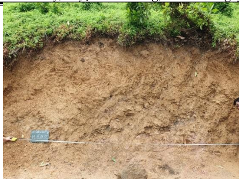
Hình 2.1: Tầng đất đá bị phong hoá hoàn toàn tại vết lộ PL.ĐC.036
