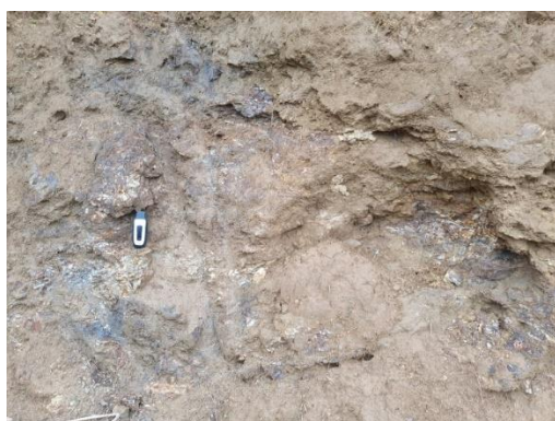
Hình 2.2: Đá phiến cát bột kết, cát kết chứa sericit phong hoá mạnh, mềm bở tại điểm khảo sát PL.ĐC.087
