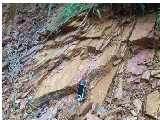
Hình 2.3: Đá cát bột kết phong hoá mạnh đến trung bình màu xám nâu, tím gụ tại điểm khảo sát PL.ĐC.073
