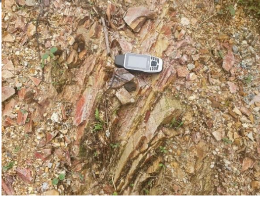
Hình 2.4: Đá phiến sét, sét - sericit phong hoá mạnh màu xám nâu, nâu tím tại điểm khảo sát PL.ĐC.072
