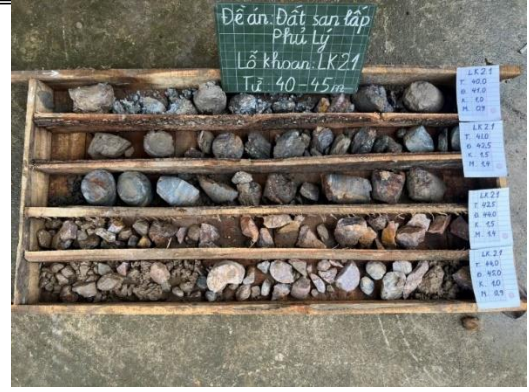
Hình 2.5: Đá phiến sét silic, phiến cát bột kết đập vỡ nứt nẻ mạnh, phong hoá trung bình đến mạnh tại lỗ khoan LK2.1 (40-45m)
