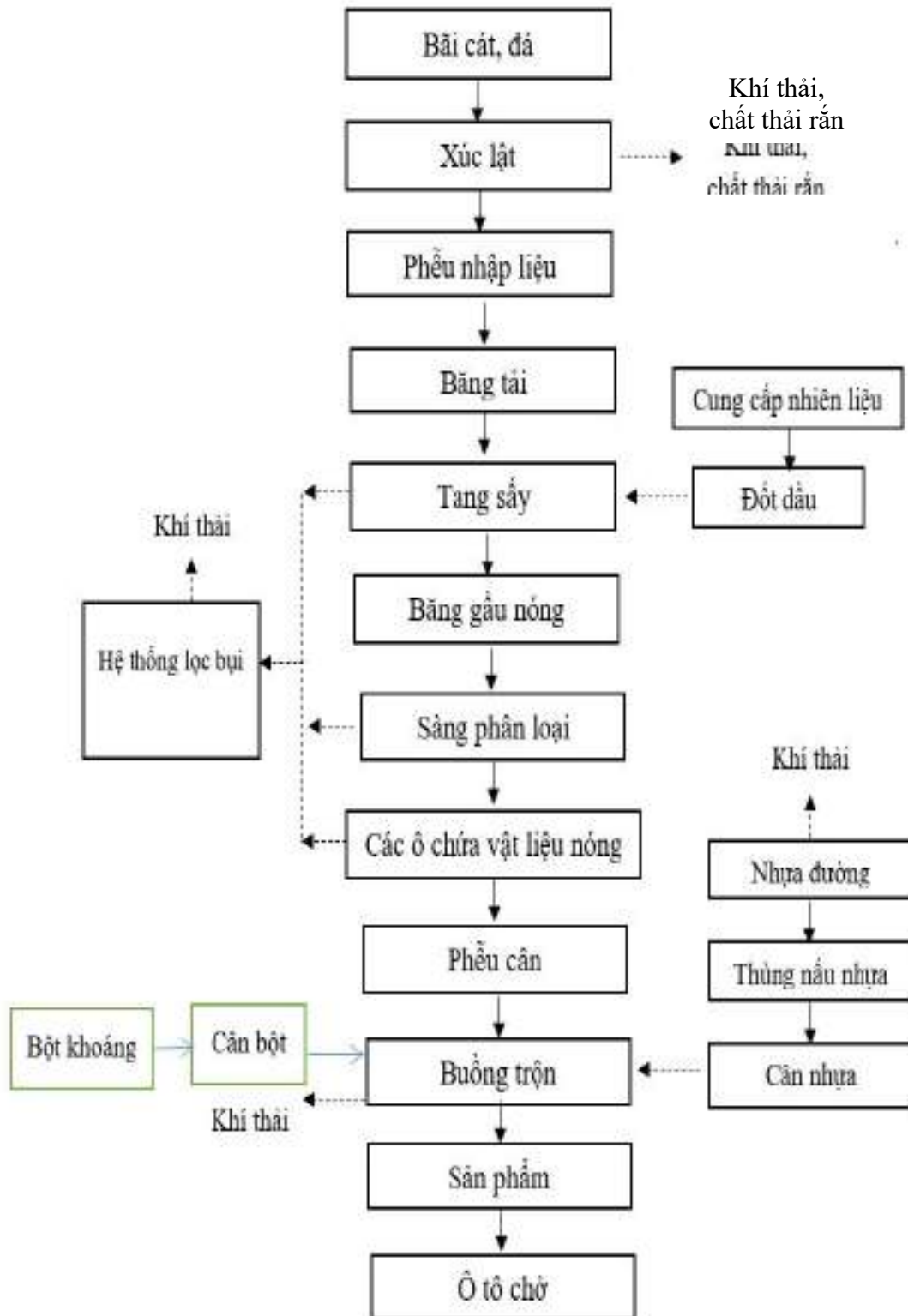
Hình 1.7. Sơ đồ công nghệ sản xuất Asphalt
