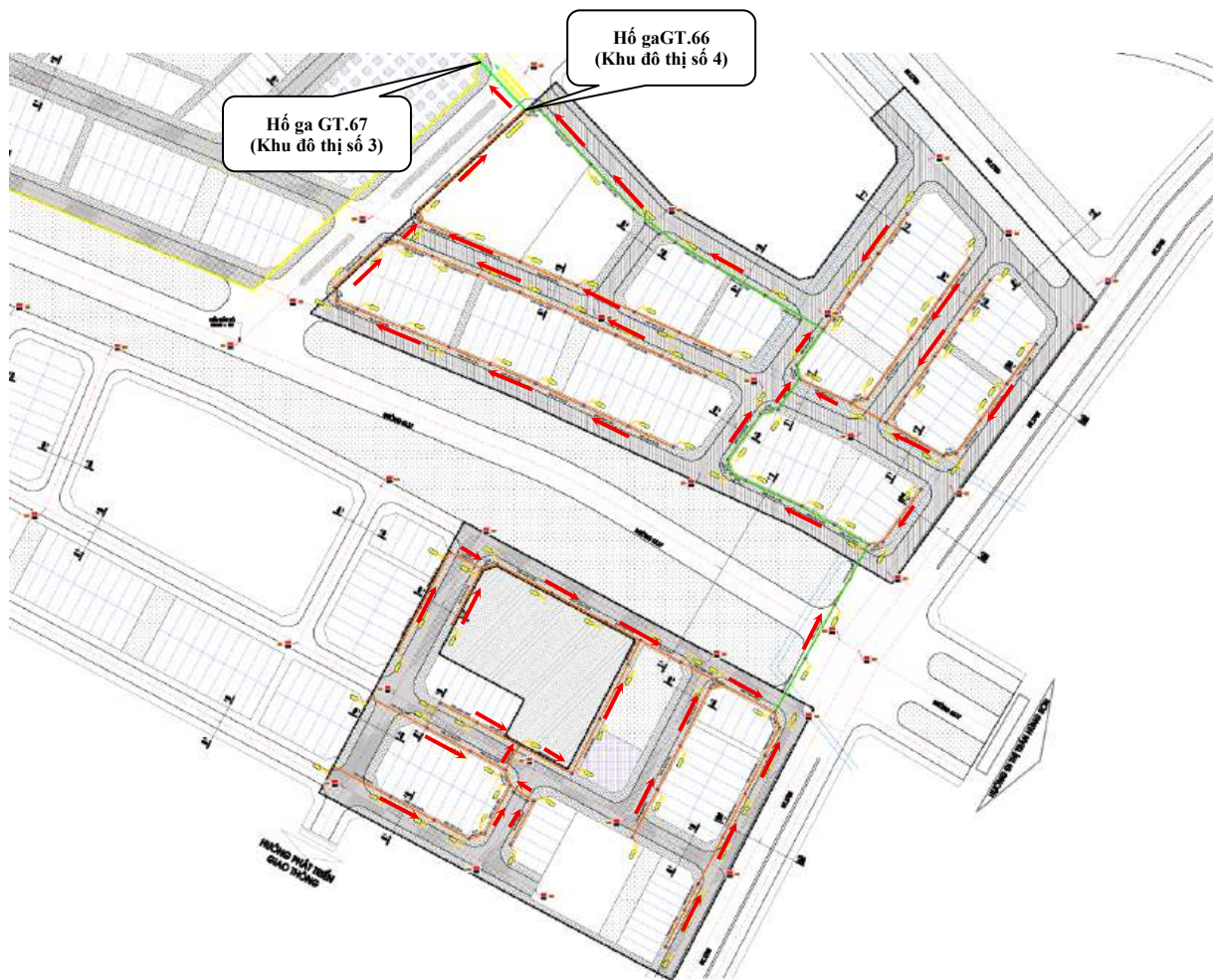
Hình 3.2. Mặt bằng thu gom, thoát nước thải
